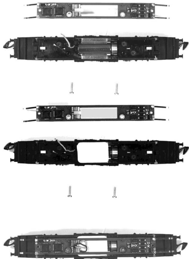
Welcher der beiden Motordrähte mit welchen der beiden Klemmen verbunden wird, ist egal. Die Motordrehrichtung kann durch Änderung der Konfiguration korrigiert werden.
