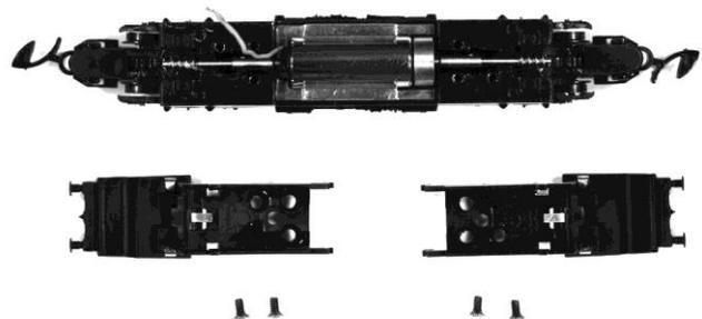
5. Beide Getriebeabdeckungen einsetzen und anschrauben. Die beiden unteren, inneren Gewinde müssen für die Decoderschrauben frei bleiben. Die Schrauben vorsichtig und nicht zu fest anziehen.
