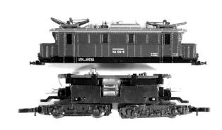
2. Die beiden Lämpchen herausnehmen, die Schraube herausdrehen und die Leiterplatte abnehmen.
