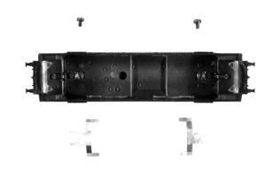
8. Vor dem Schließen des Lokgehäuses sicherstellen, dass die Motoranschlüsse keine Teile des Lokrahmens berühren oder kurzgeschlossen sind.
