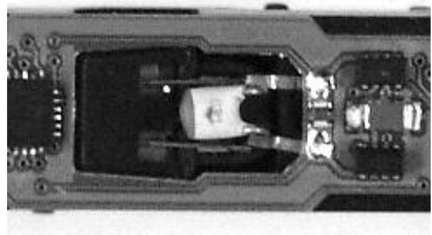
7. Den Lokdecoder mit den beiden beigelegten Schrauben befestigen.
