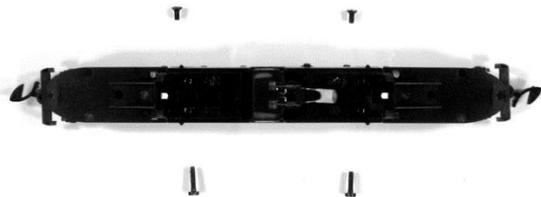
4. Die beiden kleinen Schrauben in die Gewinde der beiden zuvor herausgeschraubten großen Schrauben hineinschrauben.
