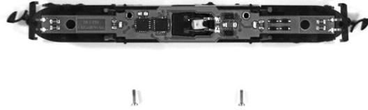
6. Wichtig ist die Lage der Motoranschlussdrähte. Sie müssen die Anschlüsse des Entstörkondensators zum Motor berühren und dürfen gegeneinander keinen Kurzschluss bilden.
