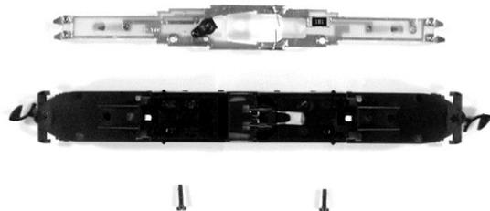
3. Die beiden kleinen Senkkopfschrauben, die sich oberhalb der beiden bereits herausgeschraubten großen Schrauben befinden, ebenfalls aus dem Lokrahmen herausdrehen.
